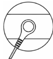
Slika 1. Način povezivanja žica i elektroda
