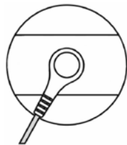
Attēls 1. Vadu un elektrodu savienojuma veids
