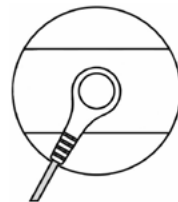
Fig. 1. Modalità di collegamento del cavo all'elettrodo
