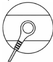
Fig. 1. Método de conexão do cabo ao eletrodo
