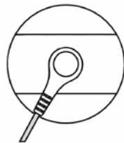
Obr. 1. Způsob připojení vodiče k elektrodě
