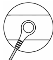
Joonis 1. Juhtme ja elektroodi ühendamise viis
