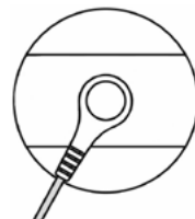
Rys. 1. Sposób podłączenia przewodu do elektrody
