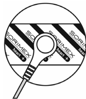
Fig. 1. Modalità di collegamento del cavo all'elettrodo
